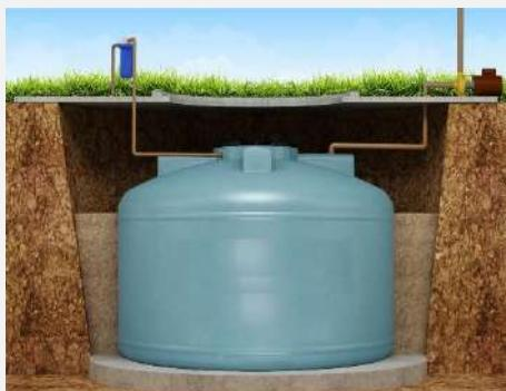
Este sistema é bastante utilizado. Antes de ser armazenada nesta cisterna, a água passa por um filtro que tem o objetivo de separar mecanicamente resíduos que poderiam estar no telhado. As cisternas podem ter diferentes tamanhos de acordo com a necessidade.
